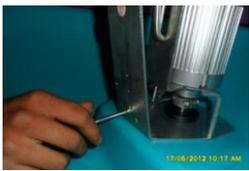
6.确认无误后用配套的Φ4MM 内六角扳手将传动轴的两颗紧固螺丝拧紧（2个）。
