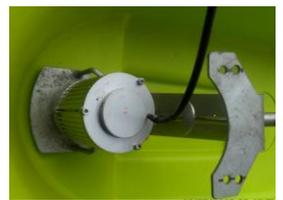
3.将自下往上穿入的传动轴（内有卡槽）的一端对准马达下端的紧固套（注意马达传动端的卡槽方向必须对准传动轴的卡槽，并用力插入，如插不进去可稍旋转传动轴即可插入，直到传动轴上黑色的记号线与船体扣件的底端对齐。）
