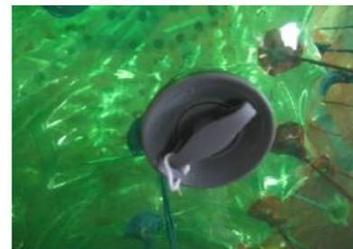
9.在发现气嘴边缘漏气时, 用维修把套入气嘴的槽内然后顺时针锁紧。最后旋紧盖子
